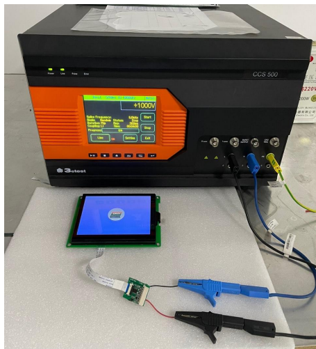
3.2 群脉冲测试图 EFT test
